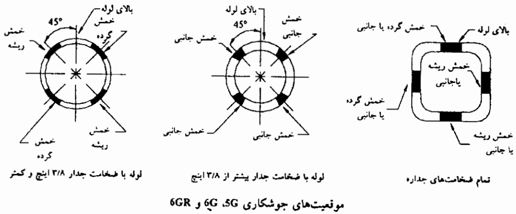
شکل ۴-۳۳- موقعیت تهیه نمونه آزمایشی از مقاطع لوله ای و جعبه ای جوشی - تعیین صلاحیت جوشکار (بند ۴-۱۹-۱-۲)
